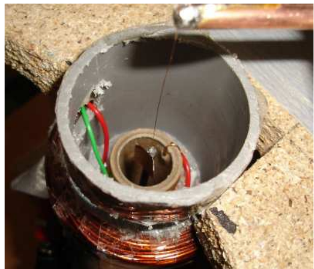
Abbildung 3: Nahaufnahme von Spule, Spiegel, Torsionsdraht
